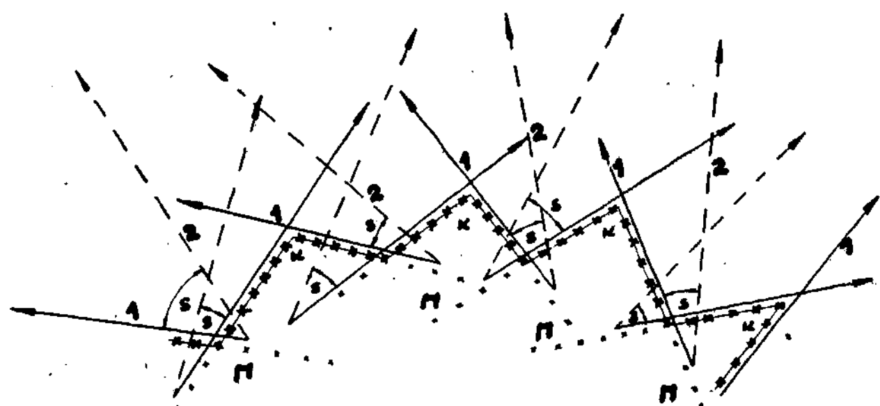
1 brėž. Kliūčių derinimas su sunk. kulkosvaidžių ugnimi: 1, 1... — pagrindinės s. kulk. šaudymo kryptys; 2, 2... — tolesni s. kulk. uždaviniai, kol dar priešas nuo kliūčių toli; S, S... — s. kulk. šaudymo sektoriai; K, K... — įvairios vielų kliūtys, sutampančios su pagr. s. k. šaud. kryptimis; M, M... — kliūčių tęsinys pozicijai maskuoti (gali būti viela neapraigyti basliai).
