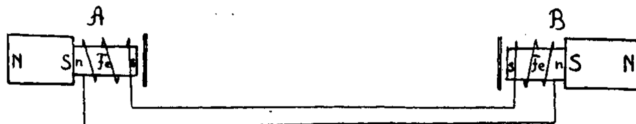
8. brėž. Bell'io telefono principinė schema
