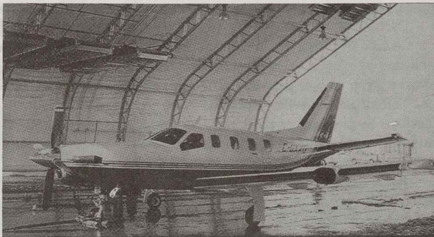
Panaudojant infraraudonąją spinduliavimą, tarptautiniame aerodrome Buffalo, NY, nutirpinami ledai nuo privataus lėktuvo.
